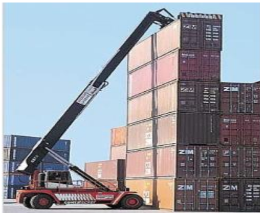
Xe nâng vỏ container (loại chụp nóc) Empty container handler (with side-lift spreader)
